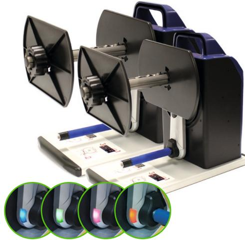
Legen Sie eine bis zu 178 mm breite Rolle in den RW-7 oder eine bis zu 120 mm breite Rolle in den RW-4 ein. Dabei ist es egal, ob sie nach außen oder innen gewickelt ist. Der Arm kann ein Rollengewicht von bis zu 5 kg tragen und mit den Kernadaptern sind Sie äußerst flexibel. Wechseln Sie ganz einfach von 1"-Kernen (ohne Adapter) zu 1,5"-, 2"- oder 3"-Kernen.
